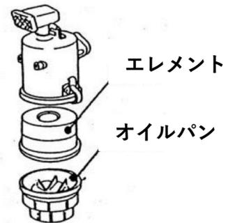
写真の図示部のクランプを外し、オイルパンを外してください。オイルパンの中の泥や草屑などをきれいに洗浄し、新しいエンジンオイル（SAE10W-30相当）をレベル線まで入れてください。
