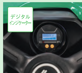
エンジンオイルとHSTオイルの警告 バッテリー電圧とアワメーターの表示
