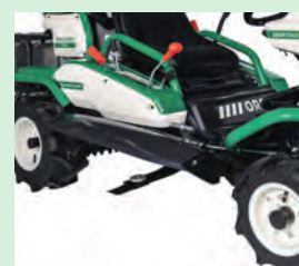
左右のサイドカバーが開閉でき 開閉幅も従来に比べ拡大
